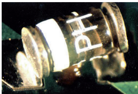
Bauteil sitzt angewinkelt auf dem Kleberpunkt
