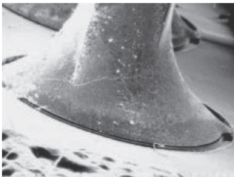
Spalt an der Lötstelle
