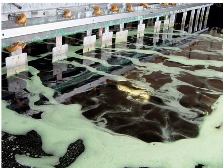
Abb. 30: Blick in ein Elektrolytbad für das Elektropolieren von Edelstahl. Die Schaumbildung beruht auf der Bildung von Sauerstoff am Werkstück (Anode) und Wasserstoff an der Kathode
