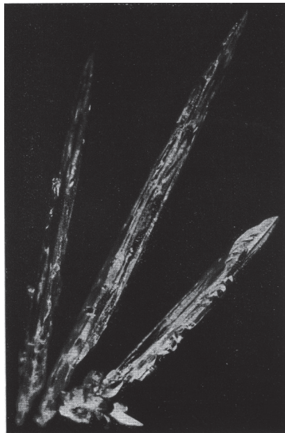
Abb. 2.4: Strukturbild des Feldorientierten Isolationstyps [7, S. 429] (Quelle: Springer-Verlag)
