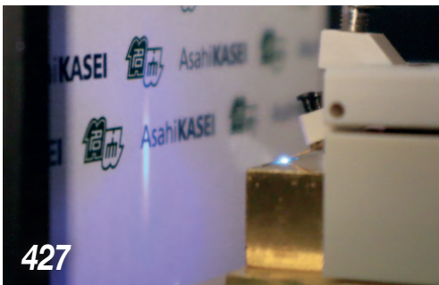
Die erste Laserdiode, die tief-ultraviolettes Licht (UV-C) bei 271,8 Nanometern emittiert. Ideal in der Medizintechnik und zur Gasanalyse
